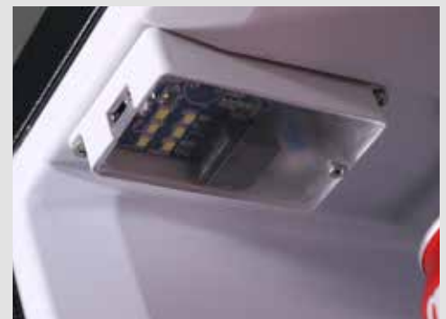
Iluminación interior mediante LEDs de bajo consumo.
