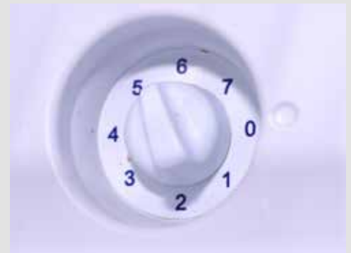
Regulador de potencia en el interior del minibar.
